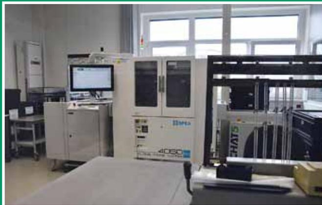
Im Prüfzentrum von Brückmann Elektronik ist das jüngste Flaggschiff – der Flying Probe 4050 von Spea – des Unternehmens untergebracht, flankiert von den Spea-Klassikern Unitest und Boardtester 3030.
